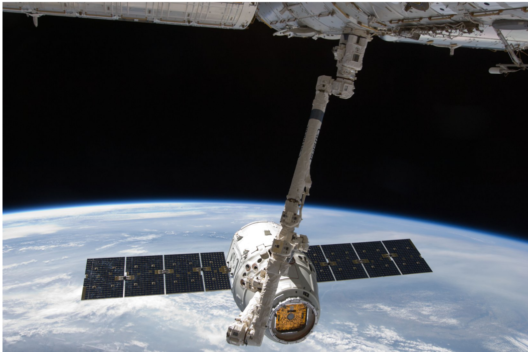
A Dragon űrhajó érkezése a Nemzetközi Űrállomáshoz. Nem rendelkezik automatikus dokkolórendszerrel és ütközéscsillapítóval sem, ezért kell robotkarral csatlakoztatni. Kép: NASA
